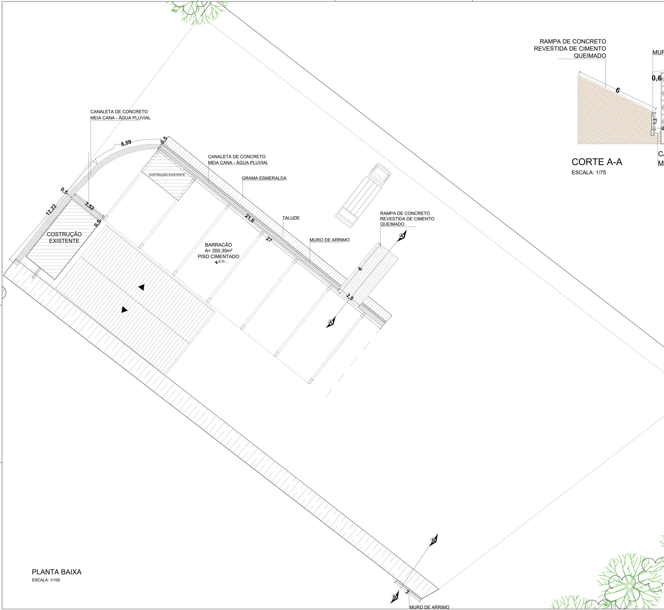
RAMPA DE CONCRETO REVESTIDA DE CIMENTO QUEIMADO
